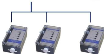
Схема прибора МГЛ: блок обработки информации и блоки первичных преобразователей (БПП) - от 1 до 20 шт.
