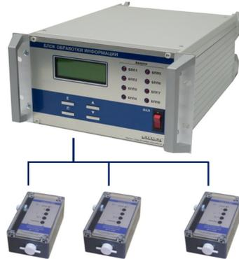
*Схема прибора МГЛ: блок обработки информации и блоки первичных преобразователей (БПП) - от 1 до 8 шт*
