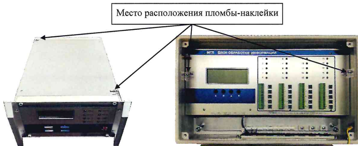
Рисунок 2а – Схема пломбировки БОИ
